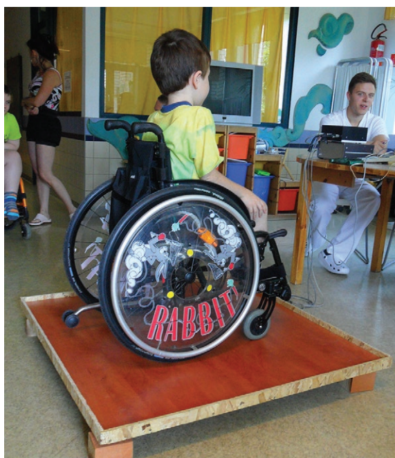
6. ábra: „Centrum” pozíciószabályozási teszt vizuális visszacsatolással. Hibajelzés: ± 15 mm pozícióvesztés esetén [Forrás: saját szerkesztés]
